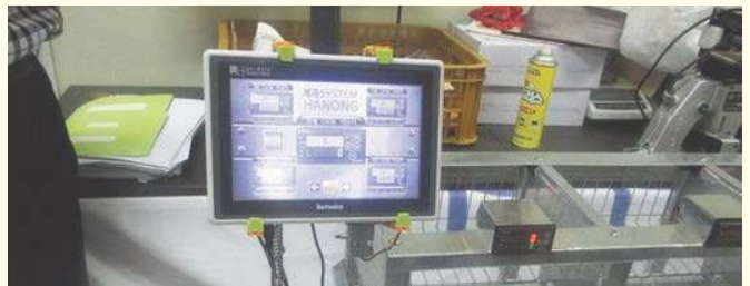
하농이 개발중인 개체별 산란개수 관리시스템(우측 사진 아래)
